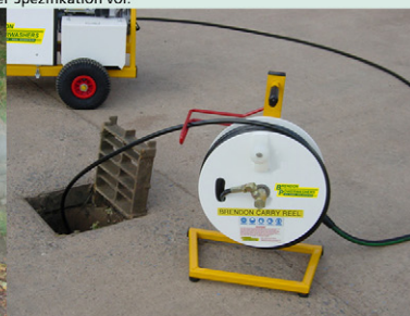
Hochdruckstrahler für Kanalisation
